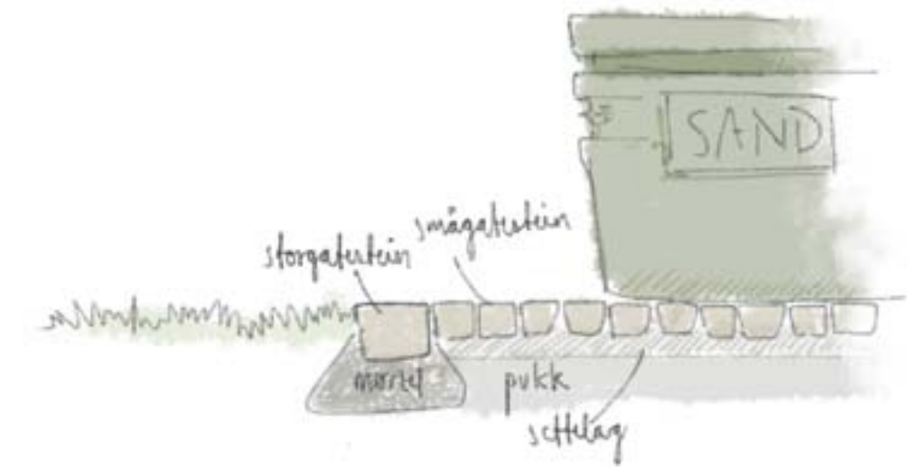
prinsippsnitt, belegg i flush med plen
