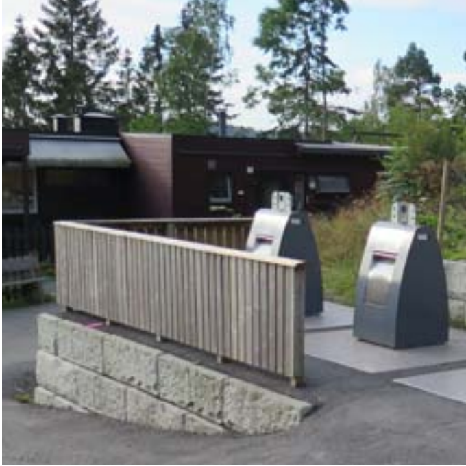
foreslått utforming med stående plank og overligger i tre
